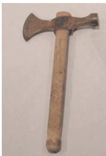
Marteau des Eaux et Forêts du début du XX e s. Le manche est en bois de chêne et la lame en fer forgé aciéré. Le marteau de forestier sert aux gardes des Eaux et Forêts pour identifier les arbres à couper. Collection particulière J. Taillardat (Onf).
