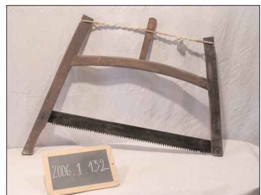
La scie à bûches avec poignée. Elle se compose d'une lame en acier tendue dans un cadre en bois en forme de H. Une corde à l'opposé de la lame peut se tendre plus ou moins en tournant une tige de bois. Collection particulière J Taillardat (Onf).
