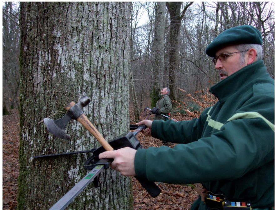
Calcul du diamètre d'un arbre avec un compas électronique en 2014. © Médiathèque ONF.
