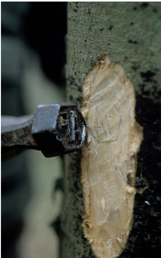
Empreinte marteau n°2, "AF", Administration Forestière pour marquer les arbres. © Médiathèque ONF.
