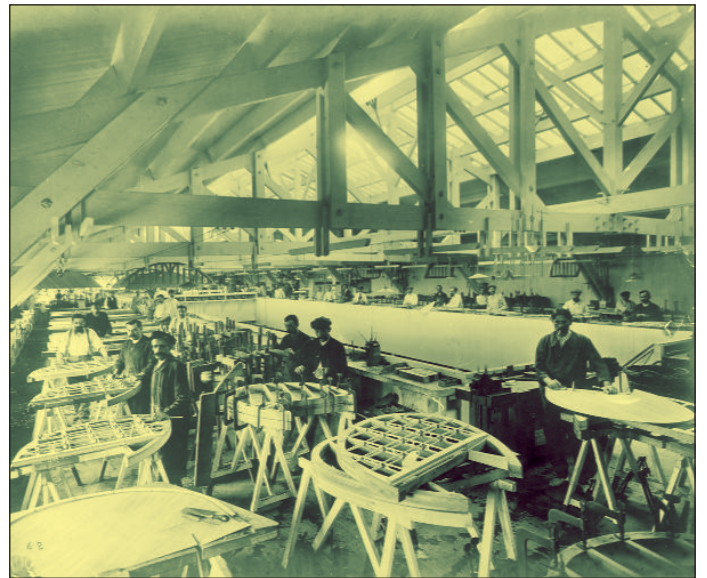
Confection en série des couples de fuselage d'avion "Nieuport". @ SHD.
