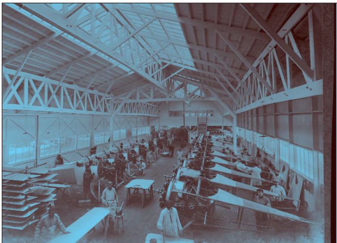
Atelier de montage des fuselages "Nieuport 16". Les dos de fuselage sont en bois moulé au milieu et en contreplaqué à l'arrière. A gauche stock d'ailes en bois. @ SHD.
